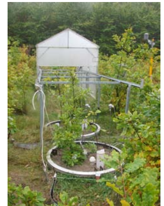
Abb. 6: (links) Wägbares Lysimeter in einem Kiefern-Buchen-Mischbestand.
