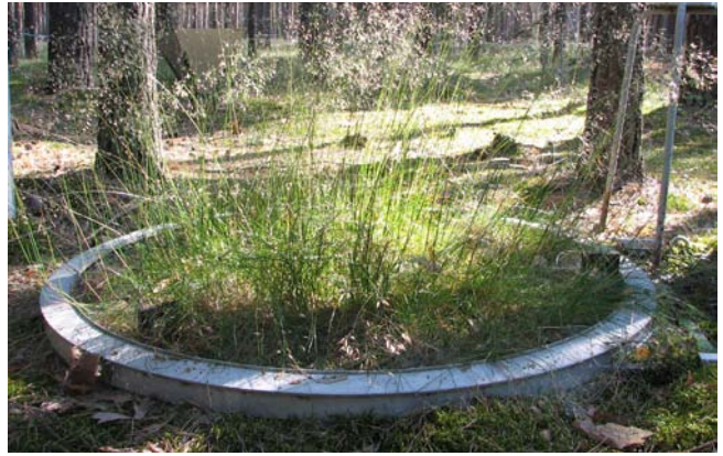
Abb. 5: Wägbares Lysimeter mit Bodenvegetation in einem Kiefernreinbestand.
