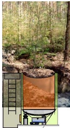
Abb. 6: (links) Wägbares Lysimeter in einem Kiefern-Buchen-Mischbestand.
