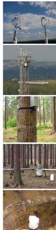
Abb. 1: Prinzipische Messanordnungen am Standort Ankerstation (Fichte) im Tharandter Wald, Stand 2010. Bildreihe rechts (von oben nach unten): Ultraschallanemometer in 42 m ü. Gr., Messmast mit oberster Messplattform und Strahlungsarm, Xylem-Saftflussmessungen und Dendrometermessungen, Doppelrinne (je 4 m lang) und Messfasser für den durchtropfenden Niederschlag, offene Bodengrube mit Bodenfeuchtemessfeld.
